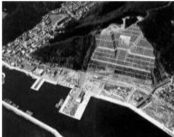
Gambar : Bukit Okushiri, Jepang Kondisi setelah kegiatan mitigasi stabilitas lereng dengan cara khemis
