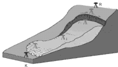
Gambar : Skema monitoring Longsor; stasiun control (R, K) pada daerah stabil; (i) stasiun monitoring pada daerah deformasi
