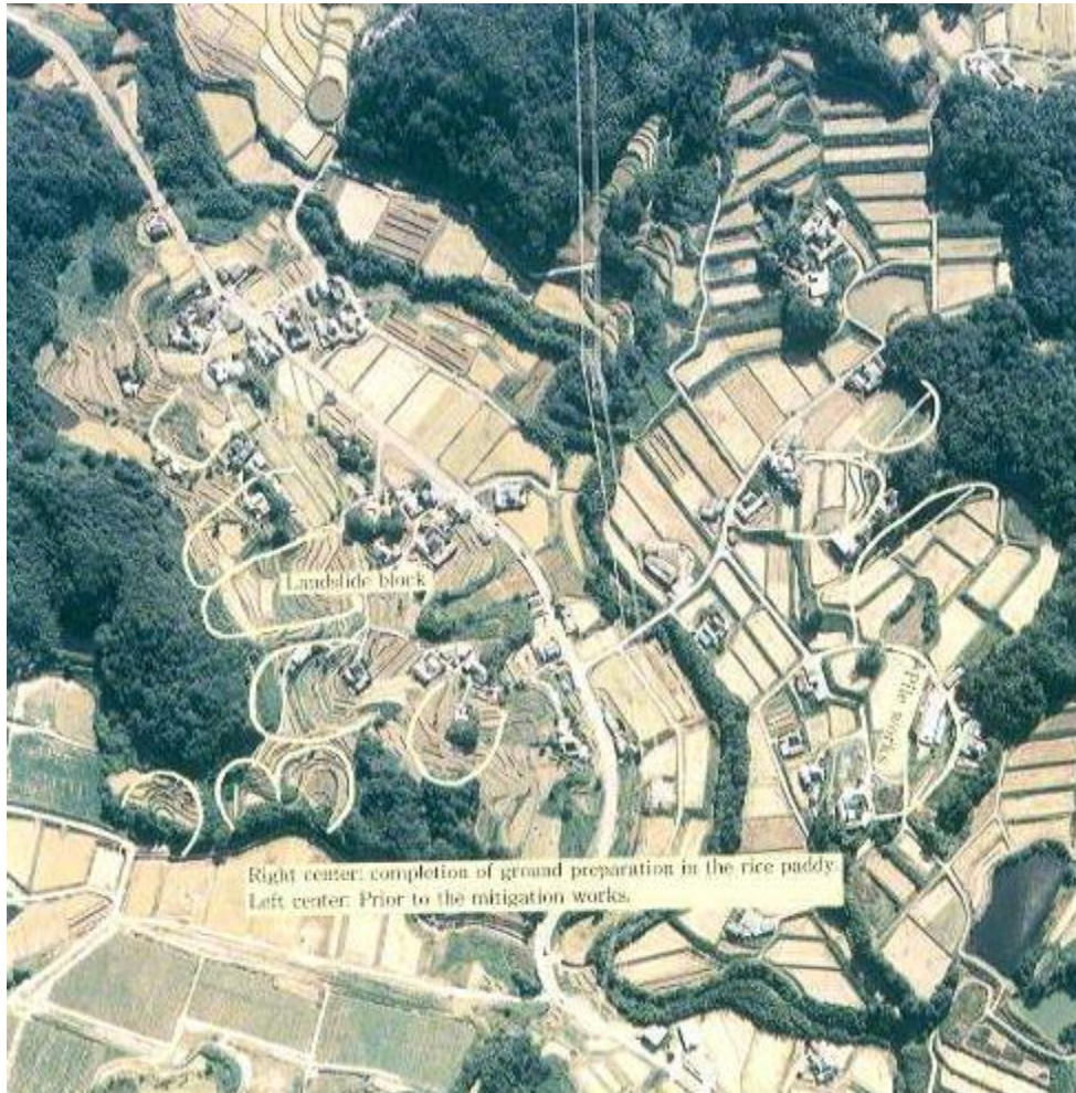
Gambar : Kita-Kobe, Jepang Mitigasi dengan pembuatan system drainase yang baik pada lereng
